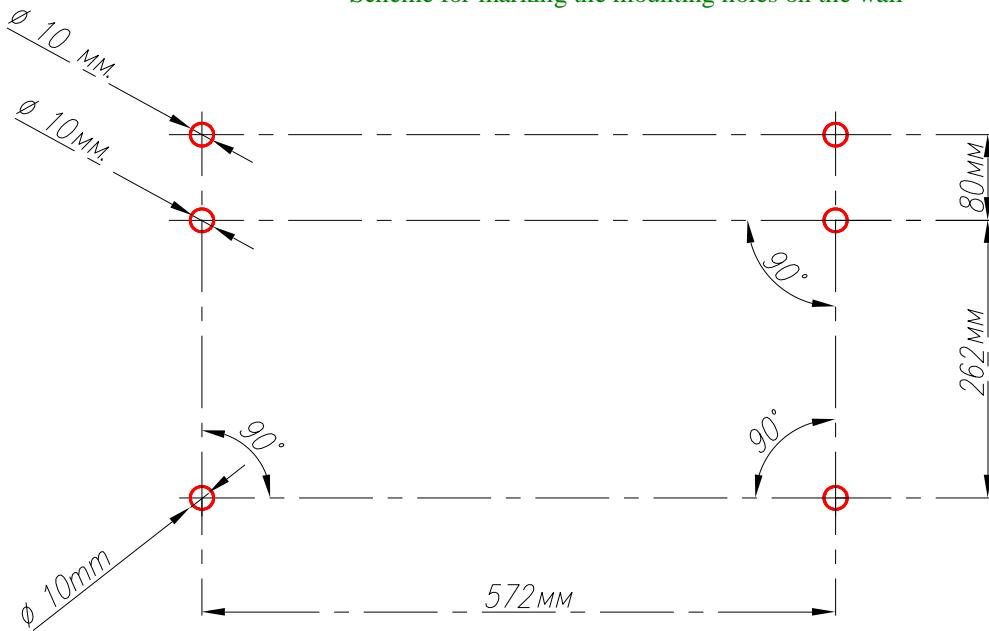
Строго придерживайтесь данных размеров, выдерживайте горизонталь. Отверстия в стене засверливайте аккуратно на нужную глубину, не допускайте разбивания отверстий при сверлении и увода сверла в сторону от намеченной точки.
