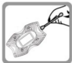
5. Используйте ватные палочки, чтобы тщательно стереть все капли воды на стыке между передней и задней частью.
